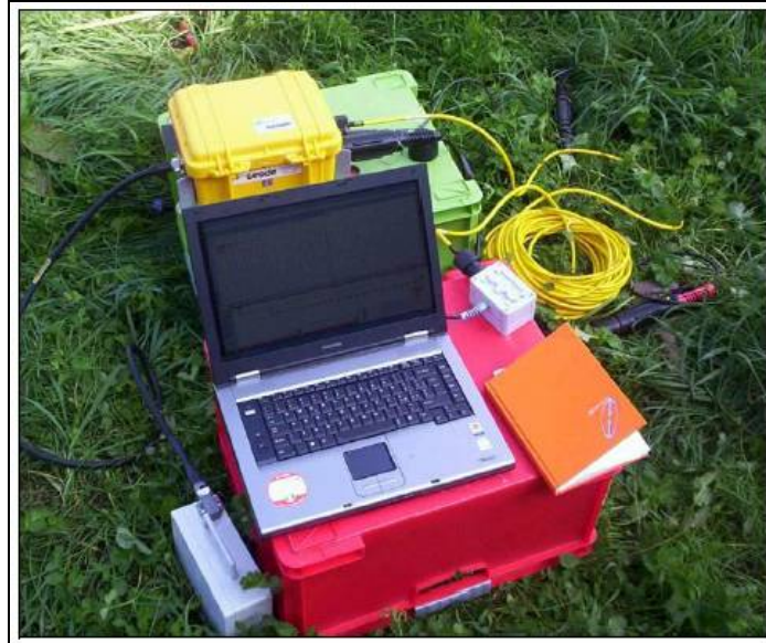
Figura 7.3: Strumentazione utilizzata per la prova MASW.
