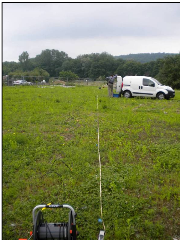
Fig. 7.9 Esecuzione dell'indagine sismica (a sinistra Masw 1 e a destra Masw 2)
