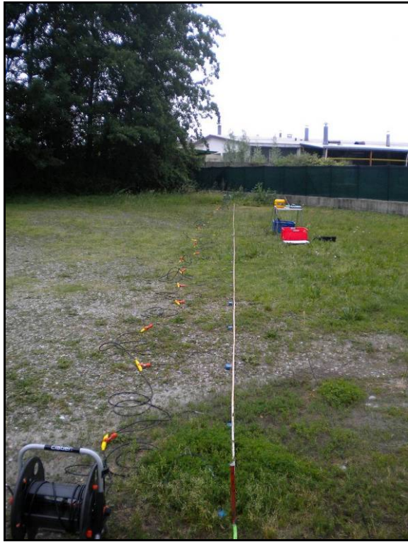
Fig. 7.10 Esecuzione dell'indagine sismica (a sinistra Masw 3 e a destra Masw 4)
