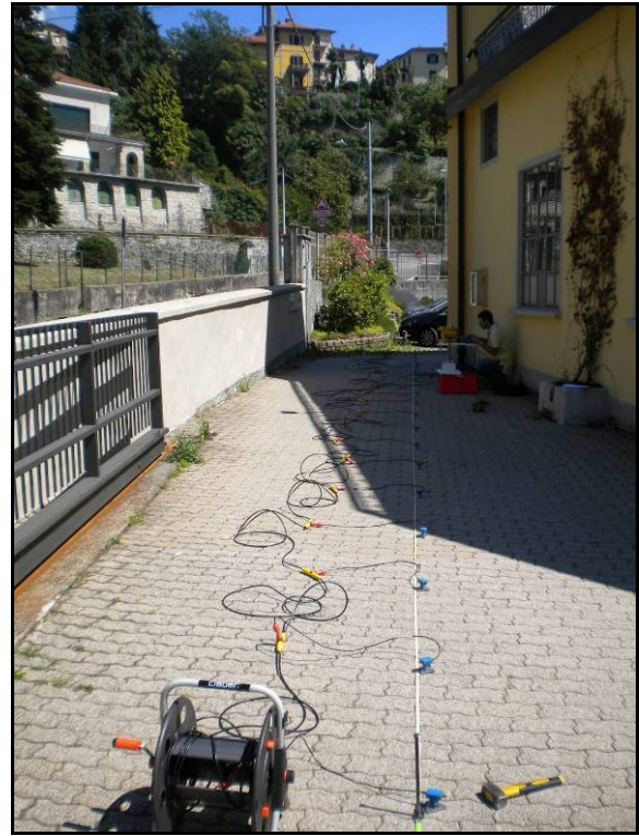
Fig. 7.10 Esecuzione dell'indagine sismica (a sinistra Masw 3 e a destra Masw 4)
