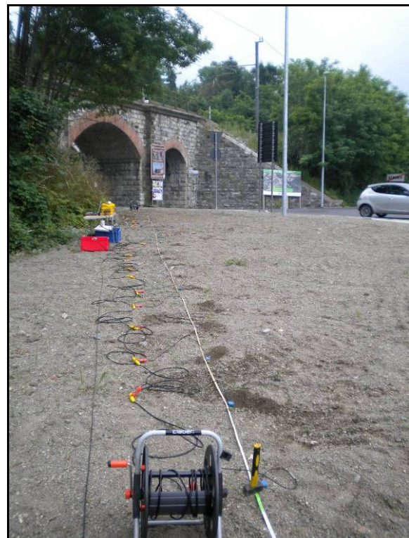
Fig. 7.9 Esecuzione dell'indagine sismica (a sinistra Masw 1 e a destra Masw 2)
